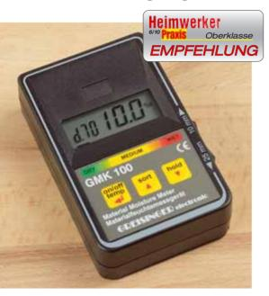
Das Materialfeuchtemessgerät ist nicht nur für Putz geeignet, auch Beton und verschiedene Holzarten können auf ihren Feuchtigkeitsgehalt geprüft werden. Früher kosteten solche Messgeräte viel Geld. Greisinger hat mit dem GMK 100 ein bezahlbares Gerät auf den Markt gebracht.
