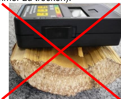
Falsch: Verworfene Oberfläche (hier extrem!)
