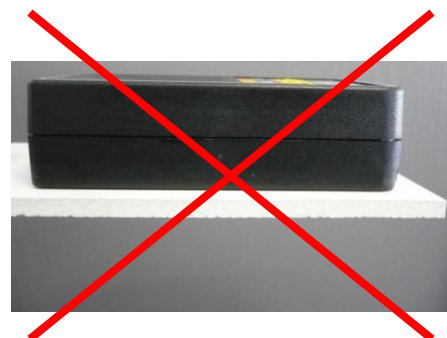
Falsch: zu geringe Materialstärke
