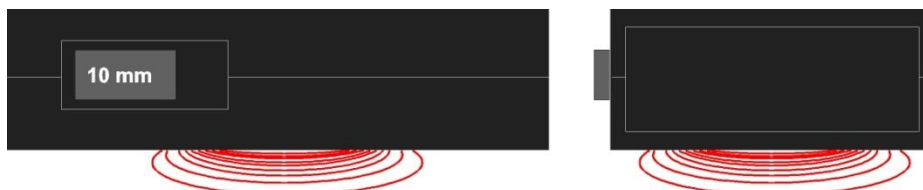
Seitenansicht: Messfeld und Eindringtiefe bei Schalterstellung „10 mm“
