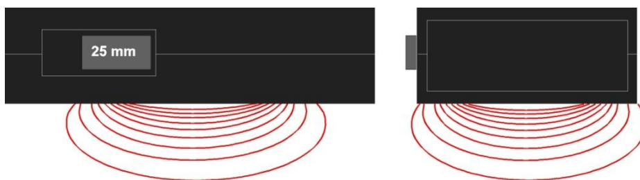
Seitenansicht: Messfeld und Eindringtiefe bei Schalterstellung „25 mm“
