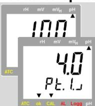
Stellen Sie die Elektrode und den Temperaturfühler (falls vorhanden) in die zweite Puffer-Lösung. (pH 4.0 oder pH 10.0) und rühren Sie vorsichtig um.
