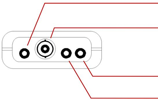
**Schnittstelle:** Anschluss für galv. getrennten Schnittstellenadapter (Zubehör: USB 3100 N, GRS 3100, GRS 3105)
