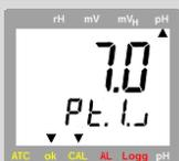
Stellen Sie die Elektrode und den Temperaturfühler (falls vorhanden) in die neutrale Lösung (pH 7) und rühren Sie vorsichtig um.
