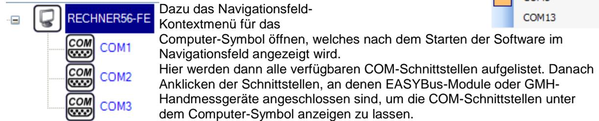
Dazu das Navigationsfeld-Kontextmenü für das Computer-Symbol öffnen, welches nach dem Starten der Software im Navigationsfeld angezeigt wird. Hier werden dann alle verfügbaren COM-Schnittstellen aufgelistet. Danach Anklicken der Schnittstellen, an denen EASYBus-Module oder GMH-Handmessgeräte angeschlossen sind, um die COM-Schnittstellen unter dem Computer-Symbol anzeigen zu lassen.
