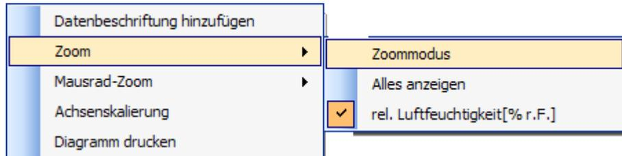
Diagramm öffnen. Danach das Untermenü 'Zoom' öffnen und die gewünschten Kurven auswählen welche zoomt werden sollen und einen Haken bei 'Zoommodus' setzen. Nun ändert sich der Cursor in ein Kreuz. Man kann jetzt einen Rahmen um den gewünschten Bereich im Diagramm ziehen, und dieser wird dann vergrößert angezeigt.
