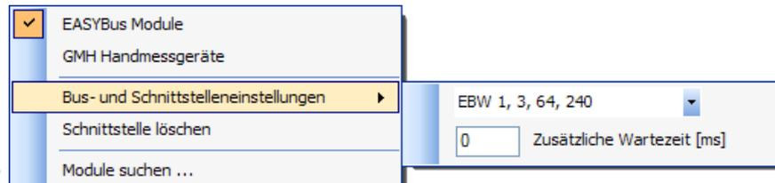
oder 'GMH Handmessgeräte' ausgewählt werden. Bei 'EASYBus Module' muss anschließend unter 'Bus- und Schnittstelleneinstellungen' der verwendete Schnittstellen-Konverter ausgewählt werden. Normalerweise ist die Auswahl 'EBW1, 3, 64, 240' korrekt. Ist ein EB 3000 im System eingebaut, so muss als Schnittstellen-Konverter immer EB 3000 ausgewählt werden.
